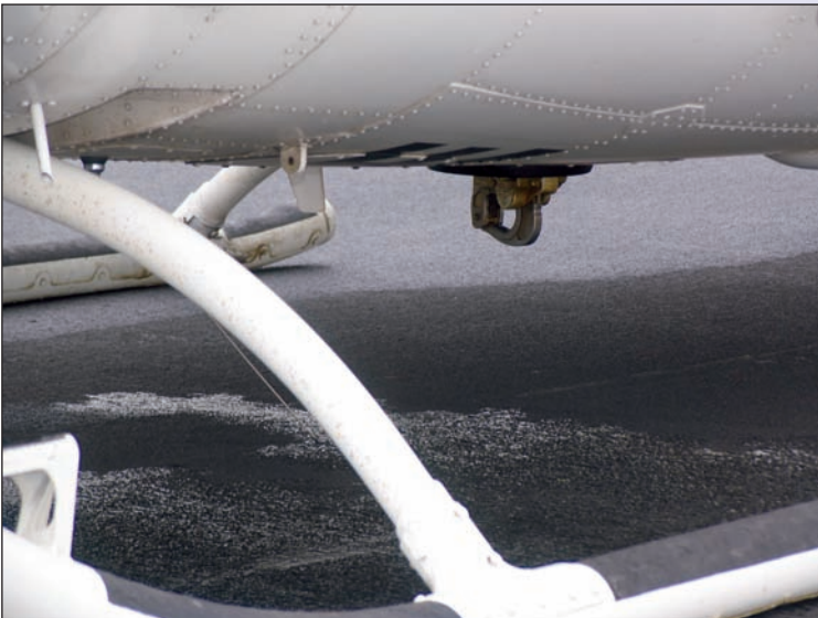
Naplněný hasicí vak váží téměř tunu, a proto se upevňuje na pevný závěs (oko) pod těžiskem vrtulníku
