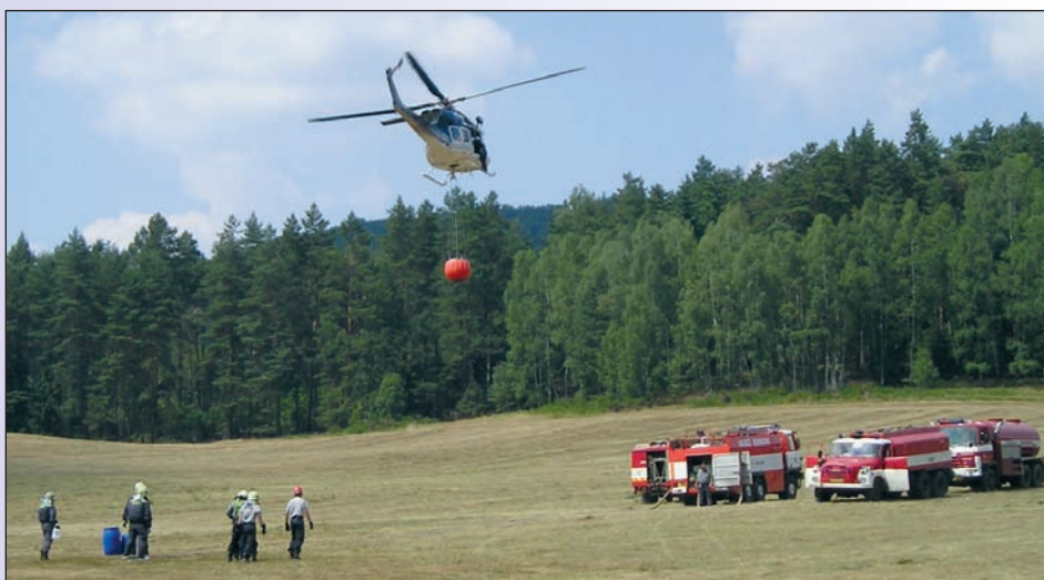
Hasičí „bambi-vak“ se plní bez přistání, nejčastěji z rybníků, z řek nebo proudnicemi z hasičských cisteren. Zabere to pokaždé jen pár sekund.
