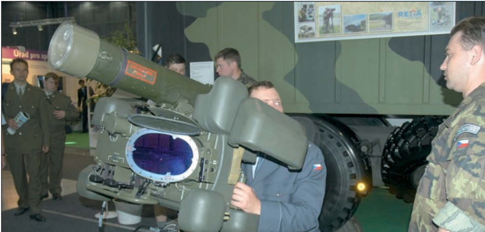
Přenosný protiletadlový komplet RBS-70 se zaměřováním střely po laserovém paprsku
