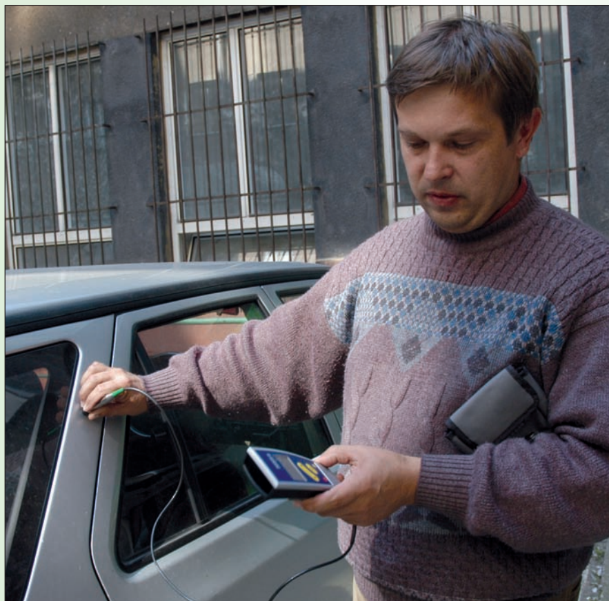
Kapitán Ing. Vladimír Audi měří ultrazvukovým tloušťkoměrem tloušťku vrstvy laku na automobilu. Souvisí to se zkoumáním identifikačních markantů vozidla.
