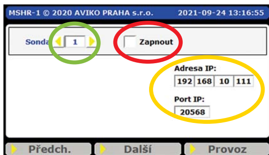
Obrázek 2.4.2. Základní zobrazení v menu „Nastavení“ pro výběr a připojení sondy ADH-3.
