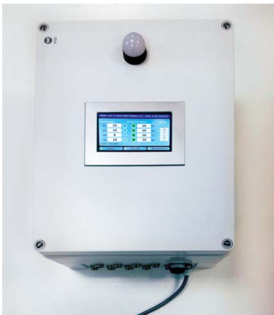
Obrázek 1.1.2B. Celkový vzhled lokální stanice MSHR-1 pro napojení integrované multifunkční sondy ADH-3.
