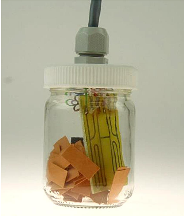
Obrázek 6 Expoziční zkouška obalového materiálu. Korozní úbytek olova je v tomto případě sledován rezistometrickou metodou, tedy technikou, kterou popisuje norma ČSN ISO 11 844-2, stejně jako metodu hmotnostní změny, kterou lze pro hodnocení agresivity obalových materiálů také využít.
